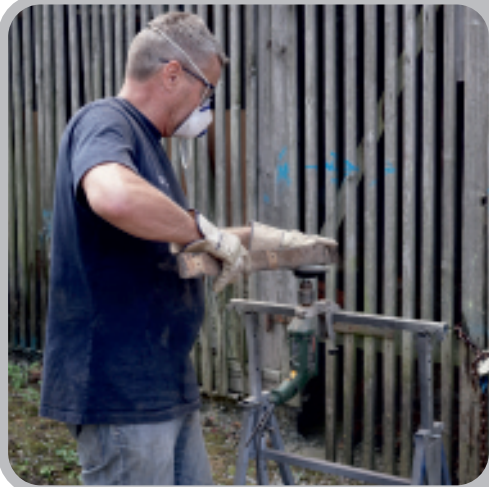
links: Abschleifen der Latten (Bild Stefan Haag) oben: Eine Bank ist fertig zum Ölen (Bild: Volker Elgner)
