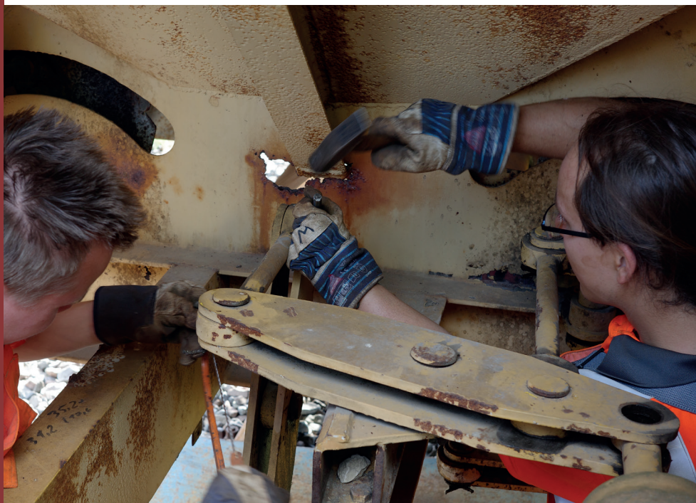
▲ Ausbau des Bremsgestänges am Schotterwagen. / Stefan Haag
