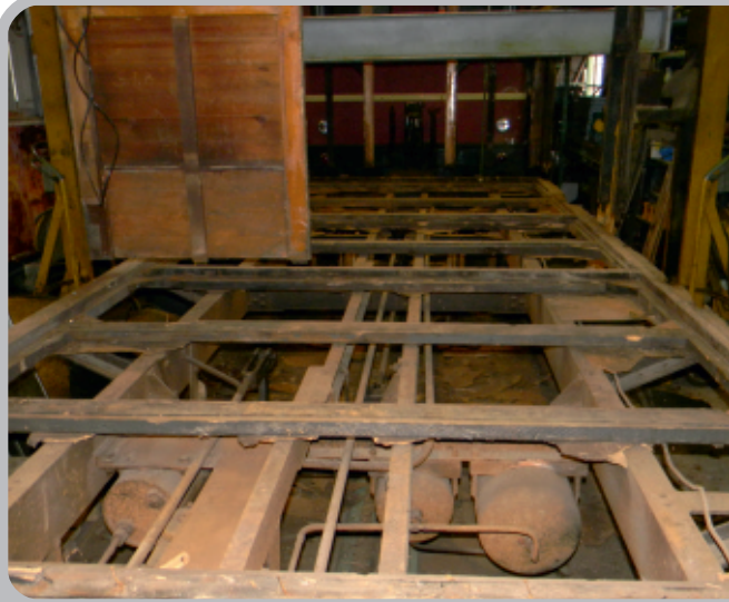
oben: Die Bodenbretter sind ausgebaut unten: Erster nächtlicher "Ausflug" des Rahmens ohne Aufbau vor den Lokschuppen (Bilder: Stefan Haag)
