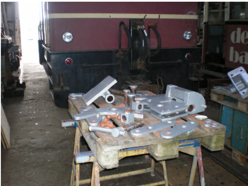
Teile des Rollbocks beim Streichen im Lokschuppen (Bild: Stefan Haag)
