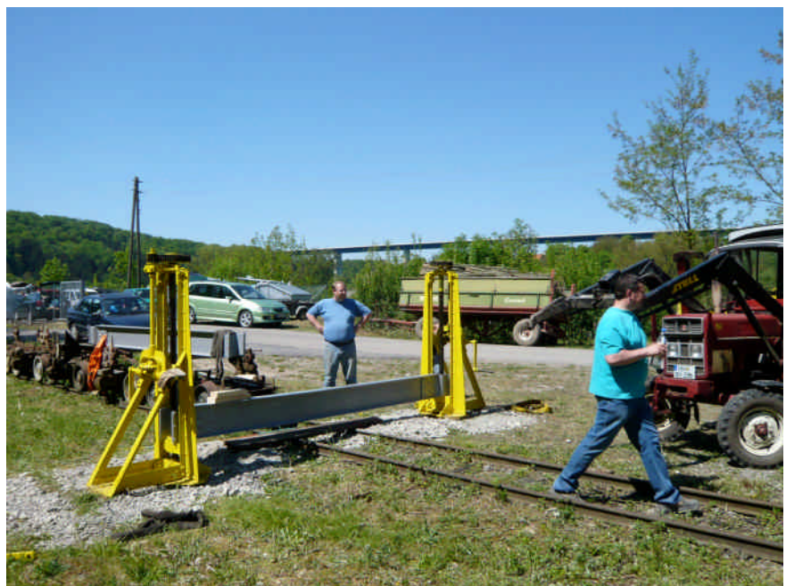
Der Hebestand für den Wagen 89 wird Aufgebaut (Bild: Frieder Strohm)
