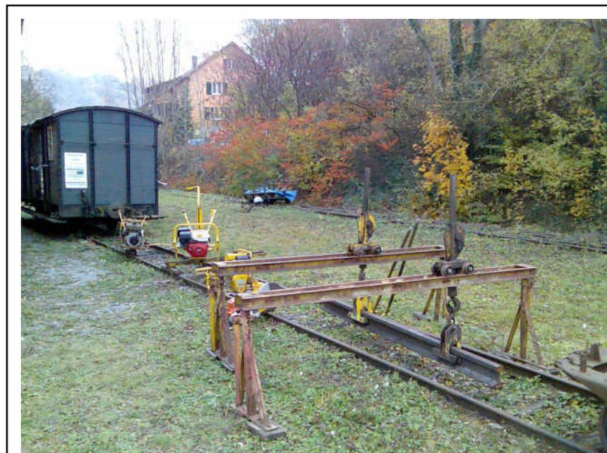
*Unsere Gleisbauwerkzeuge in der Gleisbauausstellung an der Widderner Kerwe. Von vorne nach hinten: Umsetzbocke mit Winden und Rollentragzangen, verdeckt Trennjäger und Schienenbohrmaschine, Schwellenbohrmaschine, Schrauber
