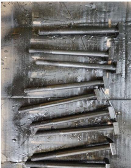
Seit Erscheinen des letzten INFOs wurde die Dachholzunterkonstruktion vorbereitet und fertig zur Montage grundiert. Die originalen Vierkantkopfschrauben waren stark korrodiert und konnten nicht mehr gerettet werden, weshalb diese von der Werkstatt neu angefertigt wurden. Diese sind erforderlich, um die Verdrehsicherheit im Holzträger zu gewährleisten.
