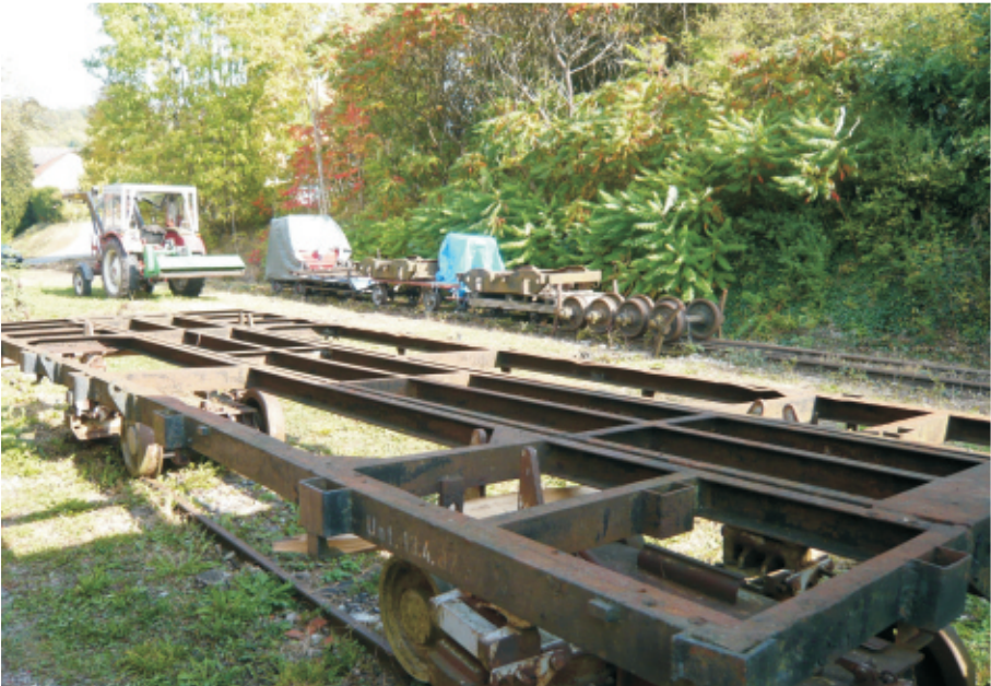
Der Rahmen und die Drehgestelle sind vorbereitet (Bild: Frieder Strohm)
