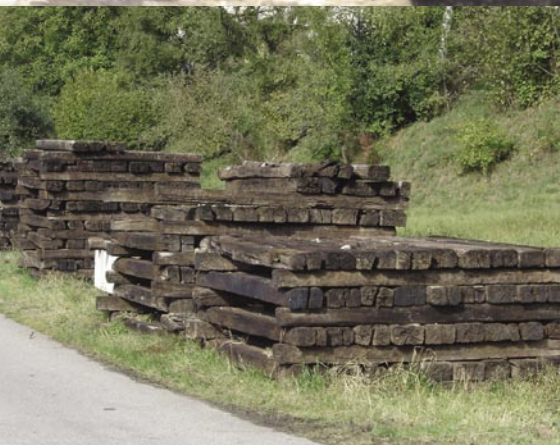
So sollen nie wieder Schwellen bei der JTB aussehen: Ausgebaute Altschwellen
