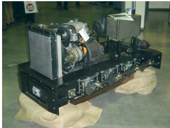
Eins unserer Lieblingsstücke in Sinsheim: Fahrwerk für ein Modell einer HF 130 C-Diesellok für 7 1/4-Zoll-Spur (Dampfbahn Plochingen).
