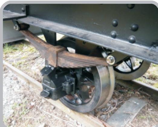
Wagen Nr. 89 wird auf seine aufgearbeiteten Radsätze abgeseht
