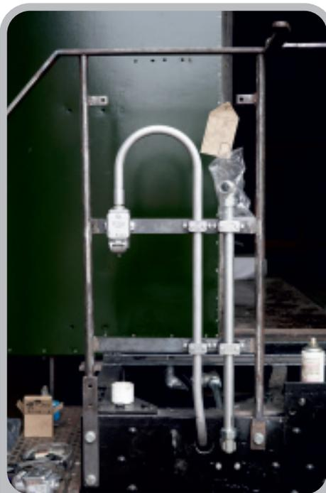
oben: Bühnengeländer mit Steckdose für die Stromversorgung und Bremsleitung
