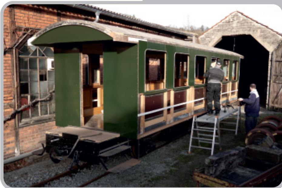
Anschließend konnten die Bremsleitung und die Leerrohre für die Elektrik mit Rohrschellen am Bühnengeländer befestigt werden. Wenn alles passt, werden wir die Geländer dann lackieren und anschließend die Kabel einziehen.
