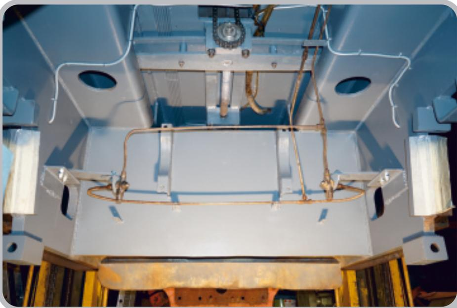
schutzschläuche ersetzt. Anschließend konnten das aufgearbeitete Bremsgestänge, die Spurkranzschmierung, der aufgearbeitete Ölsammelbehälter des Wandlers und diverse Leitungen wieder eingebaut werden.
