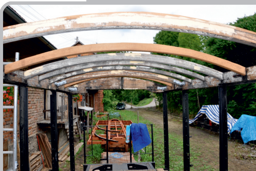
Martin Strohm auf dem Gerüst (oben) bei der Montage der Leisten, die später den Dachüberstand bilden und einer der ersetzten Dachbögen (zweiter von vorne, unteres Bild). (Bilder: Frieder Strohm)
