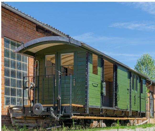
Nun wurden in die Seitenwände die Öffnungen der 3 Fenster gesägt und die Fensterrahmen eingepasst. Die heraus gesägten Bretter wurden gleich an der Stirnwand neben den Türen eingepasst, so dass der Wagen jetzt wieder komplett verbrettert ist.
